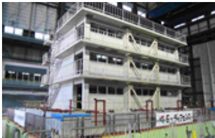
철근콘크리트 학교건축물 내진실험
